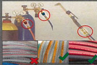
สาย Hose ที่นำมาใช้งานต้องมีการระบุประเภทชัดเจน
